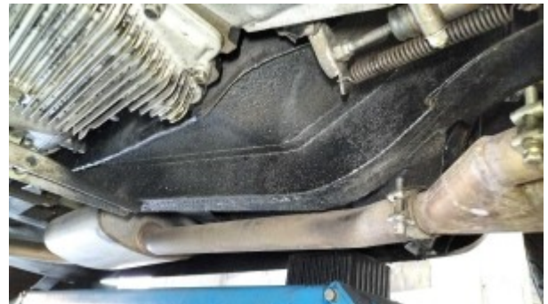
Longeron sous caisse gauche
