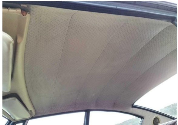
Ciel de toit
